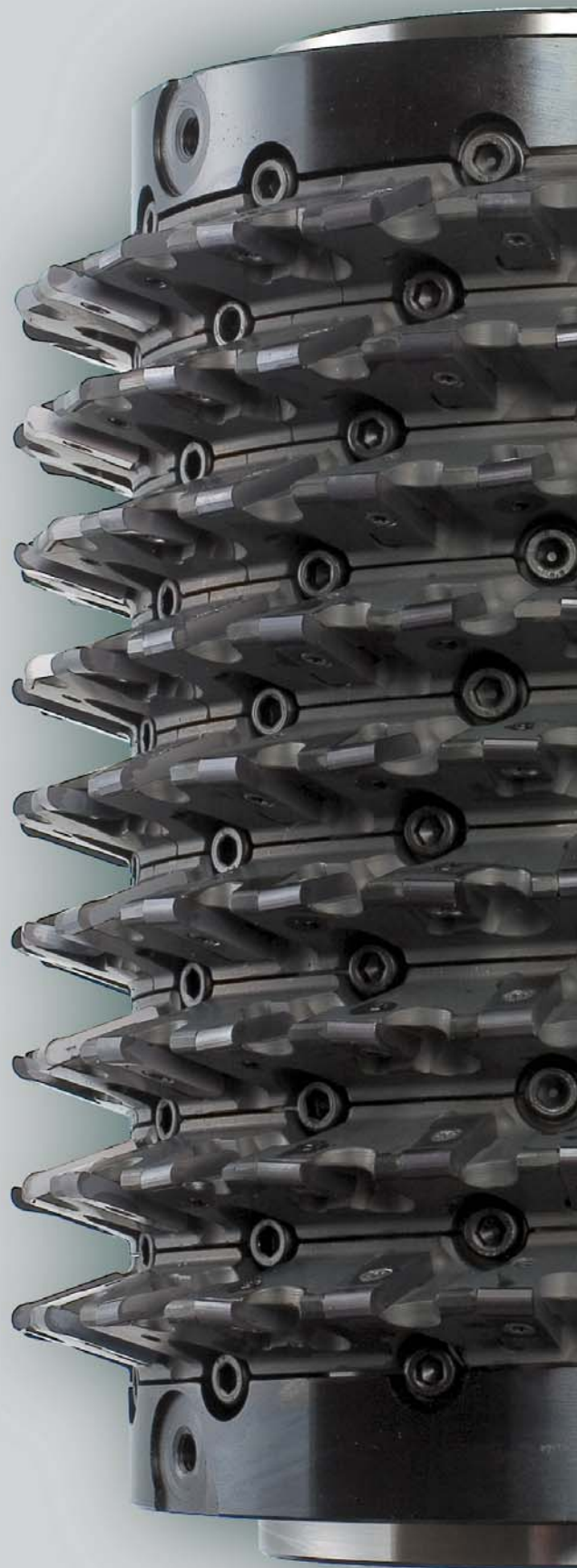
Fresas madre con plaquitas de metal duro Fresas para engranagens com placas de corte reversiveis de metal duro
